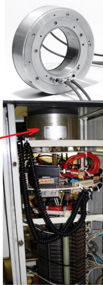
Poškodovan drseči prsten za 24Vdc napajanje tranceiverja A25,A26,A15,A16-->začasno uporabljen prašičji rep kabel (Ang. pigtail)
